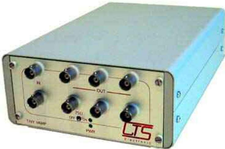
TINY VAMP ist ein Video - Distribution - Amp, der es ermöglicht eine Quelle auf sechs Verbraucher verlust - und rückwirkungsfrei zu verteilen. Zur Kaskadierung mehrerer Verstärker steht ein Durchschleif -Ein-Ausgang zur Verfügung. So kann durch die Parallelschaltung von zwei oder mehr Geräten die Anzahl der verfügbaren Ausgänge erhöht werden.
