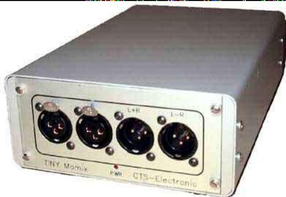
TINY MOMIX ist ein Gerät zur additiven und subtraktiven Mischung zweier Audiosignale.
