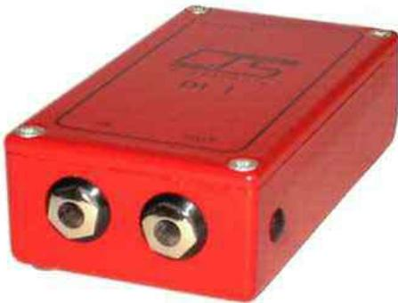
DI 1 ermöglicht die direkte Einspeisung von Musikinstrumenten in ein Mischpult. Durch eine aktive elektronische Eingangsschaltung mit sehr hoher Eingangsimpedanz (ca. 4 MOhm) werden auch empfindlichste Instrumentenausgänge nicht belastet.
