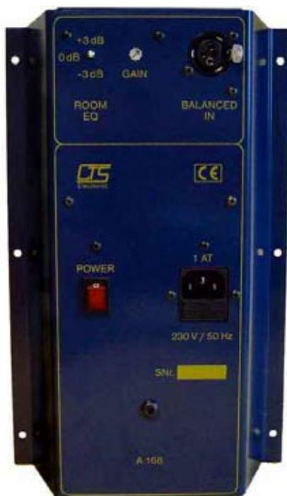
A 168 ist ein Mono - Endstufenmodul mit einer Sinusdauerleistung von 68W an 4 Ohm. Es wurde konzipiert, um auf schnellste und einfachste Weise einen passiven Studiomonitor in einen kompakten, aktiven Studiomonitor zu verwandeln. Das Modul wird mit den Lautsprecherterminals verbunden und dann einfach auf die Rückwand des passiven Monitors aufgeschraubt.
